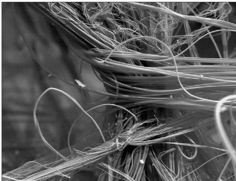
Паутина под сканирующим электронным микроскопом. Диаметр волокон от 73 до 400 нм.
